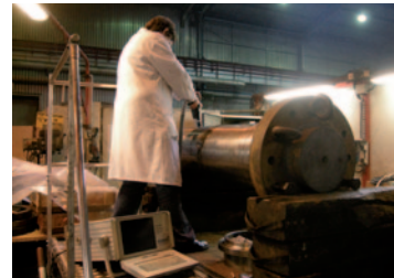
1 « Analyse d'un acier non allié par SEO portable. Le pistolet de l'analyseur par fluorescence X est de taille similaire, sans le câble »
