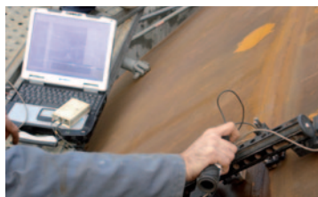
Contrôle d'une soudure par méthode TOFD
