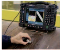
Examen d'une soudure de tubes par la méthode des multi-éléments
