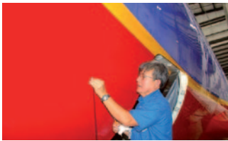
Contrôle par multi-éléments d'absence de fissure sur enveloppe d'avion
